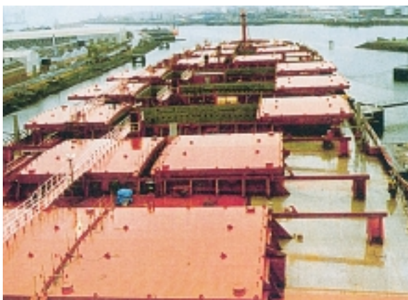
Εικόνα 13.4 (α), (β): Πλοία με καλύμματα κυλιόμενα
