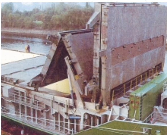
Εικόνα 13.4 (α), (β): Πλοία με καλύμματα κυλιόμενα
